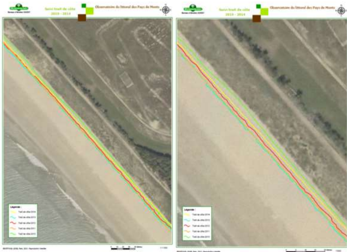
Illustration 4 : Evolution de la position du trait de côte (contact plage/dune) entre 2010 et 2014 (levés GPS) (ONF)
